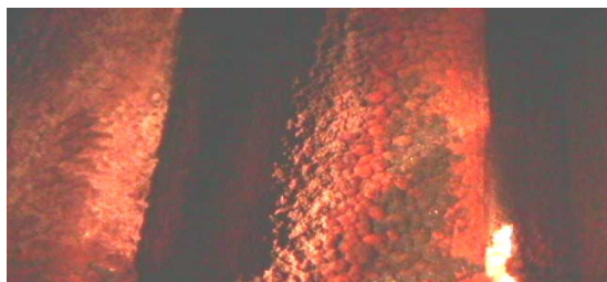
附图 3 熔盐腐蚀事故照片
