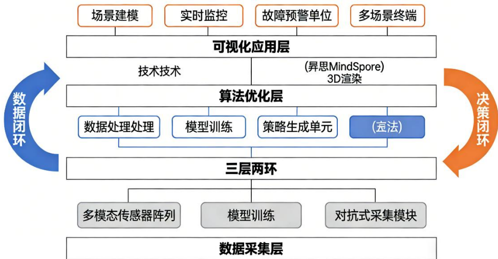
图 1 为 AI 赋能气动智能体生态系统的三层两环架构图
